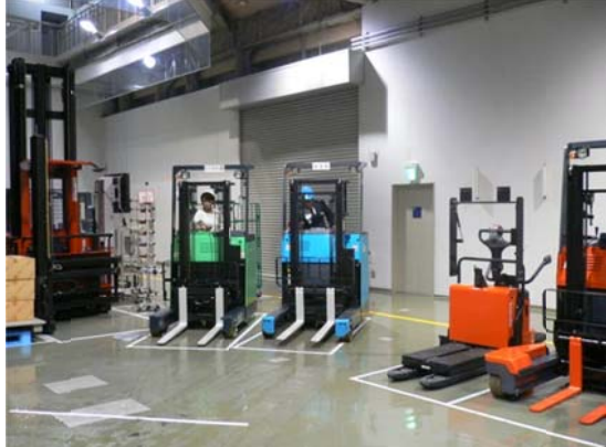
フォークリフトに試乗してのスリップテスト
